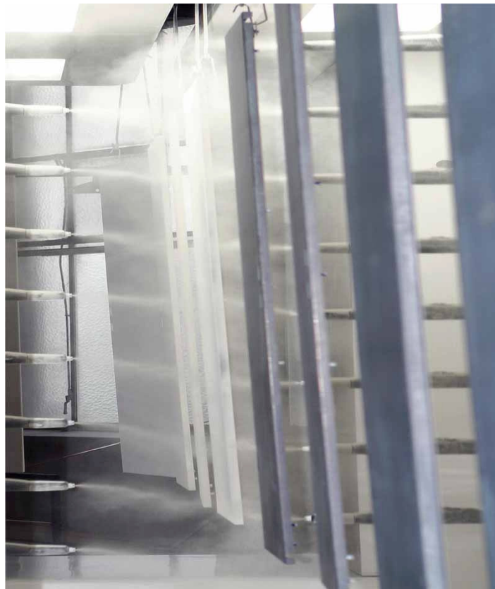
Bild: Blick in die automatische LOHMEIER Beschichtungsanlage
